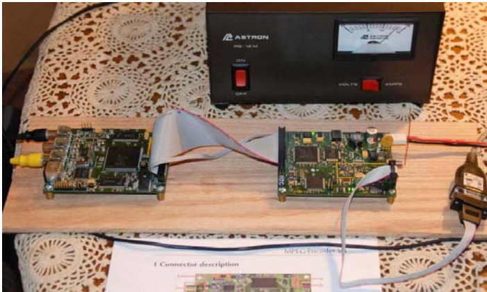
Bild 1 – MPEG-2 und DVB-S 1,2 GHz-Sender-Platinen von SR-Systems auf dem „Test-Brett“
