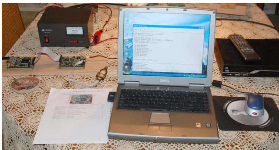
Bild 5 – Foto der gesamten D-ATV-Station – der Satelliten-STB-Empfänger steht rechts, das Notebook zur Konfiguration des Senders in der Mitte und der DVB-S-Sender links.
