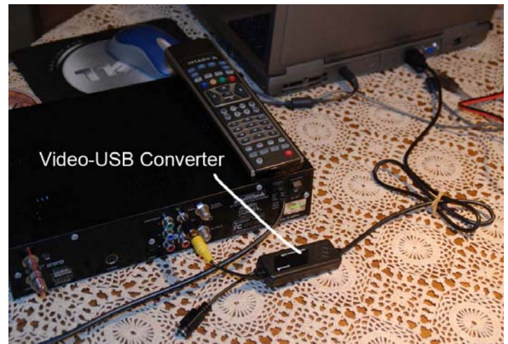
Bild 6 – Der Composite-Video-zu-USB-Konverter überträgt das Video zum Computer-USB-Port
