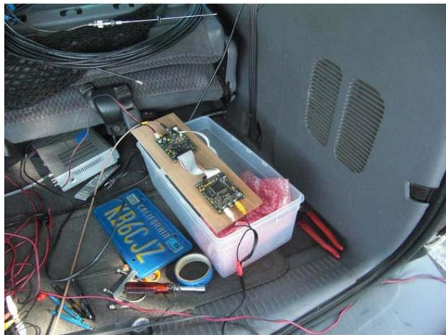
**Bild 1 – D-ATV-DVB-S 1 mW-Sender für 1,2 GHz**
